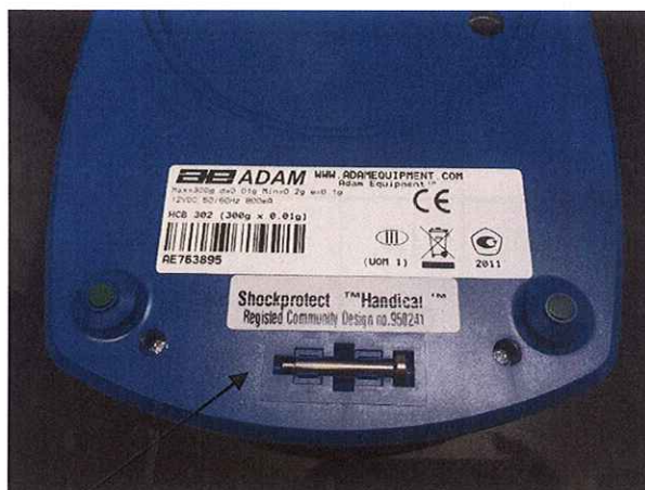
Рисунок 2 – Место нанесения свинцовой пломбы
