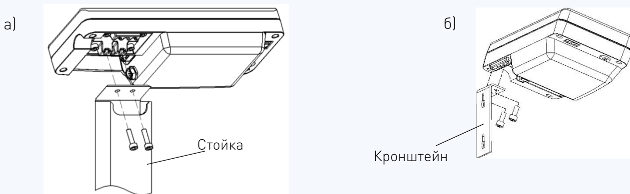
Рис. 5.2. - Варианты крепления устройства управления
